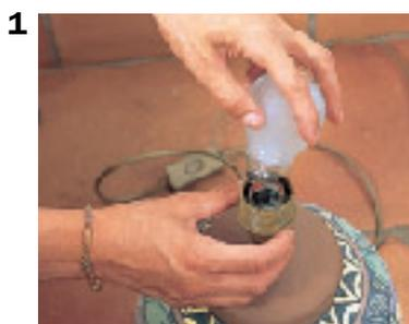
1. Il arrive que l'ampoule se détache de son culot lorsqu'on veut l'enlever et que le culot reste en place.
